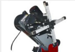
Utilizando os extensores o equipamento pode montar e desmontar rodas de até aro 56 polegadas
