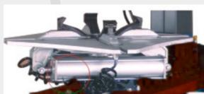
Pistões da mesa giratória com 80mm, para aumentar a força de fixação das rodas.
