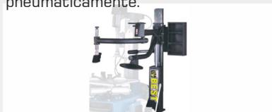
Equipamento equipado com braço auxiliar direito, possibilidade enorme facilidade na montagem de pneus com perfil baixo.
