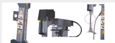
Coluna com dupla nervura, tornando-se muito mais forte. O braço horizontal com 50 milímetros garante a força resistência de flexão. O eixo sextavado é feito de aço S41, que pode evitar torção quando operar com pneu perfil baixo.
