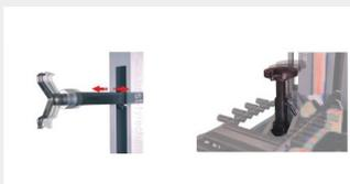
O cabeçote montador e desmontador, pode ser ajustado, possibilitando a montagem de rodas de tamanhos variados.
