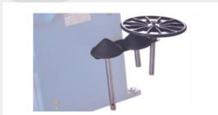
Os discos de centralização, além da função de centralizar o braço auxiliar na roda, também pode pressionar a roda para baixo, tornando assim mais fácil a fixação das garras.
